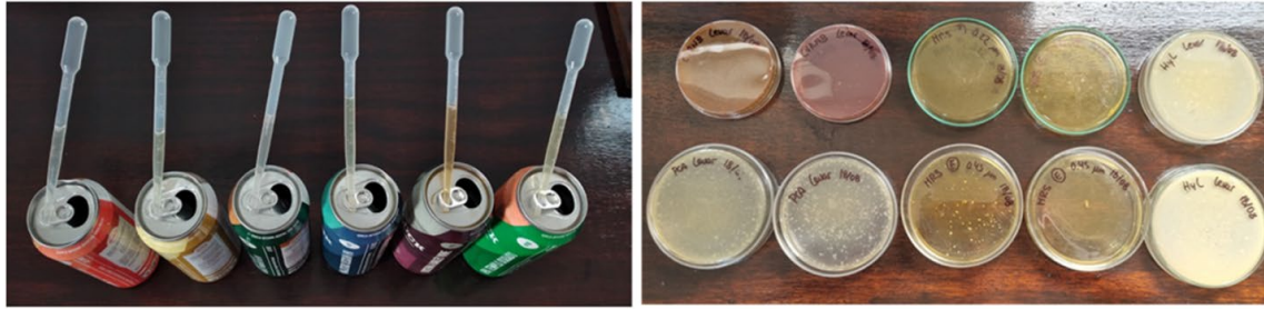
Fig 1a. Determinación de SRM en muestras de cerveza de diferentes estilos. Fig 1 b. Capsulas de Petri correspondientes a siembras microbiológicas en medios de cultivo específicos.
